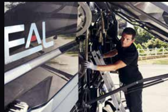
Hordozható hátsó létra könnyíti meg a magasan elhelyezkedő részek hozzáférését a gép körül
