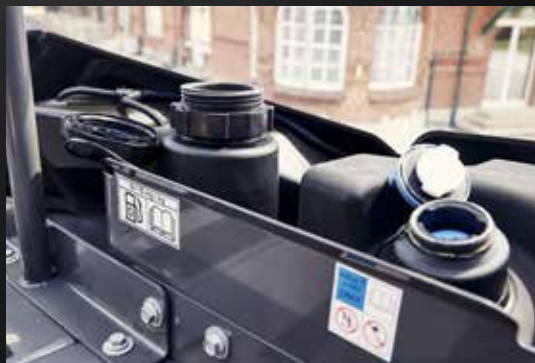
Egyszerű üzemanyag-feltöltés – a kényelmes hozzáférés érdekében a dízel- és az AdBlue-tartály egymás mellett helyezkedik el
