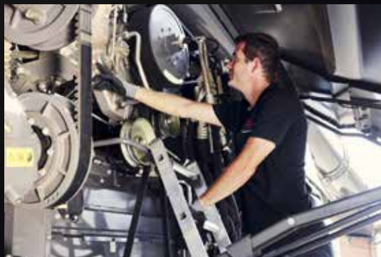
Egyszerűsített erőátvitel kevés szíjjal és láncsal
