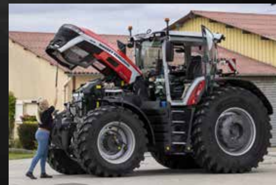
A mellső híd és a „karcsúsított” motorháztető kialakításának köszönhetően az olajsint-ellenőrző nivópálca és a szűrő is könnyen hozzáférhető.
