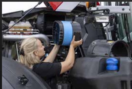
A motor légszűrője könnyen hozzáférhető és tisztítható.
